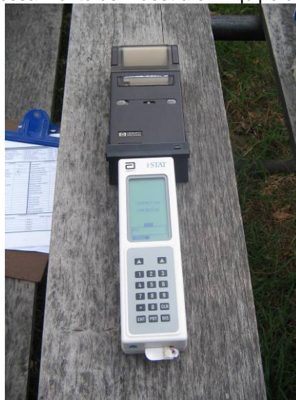
Figura 24. Procesamiento de muestra en Equipo de i-Stat Analyzer.
